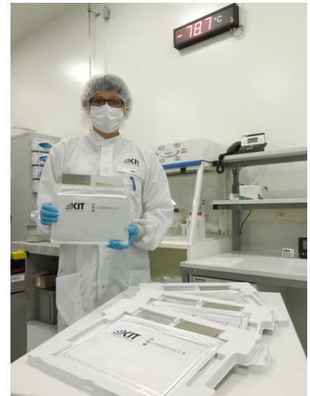
Dank des Trockenraums mit einem Taupunkt von fast -80\text{ °C} lassen sich hochwertige Batterien zusammenbauen. (Bild: KIT)
